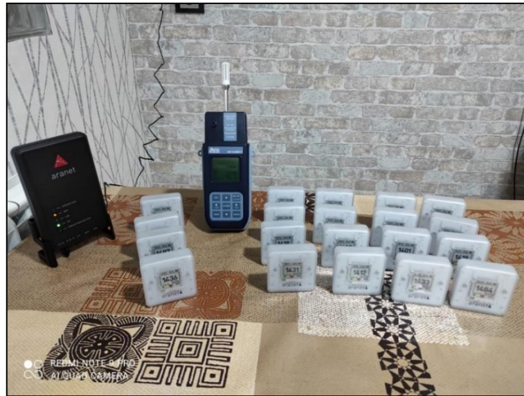
Figura 3.1. Medidores de CO 2 Aranet4 Pro junto con la estación base de Aranet y el medidor de referencia Delta Ohm.
