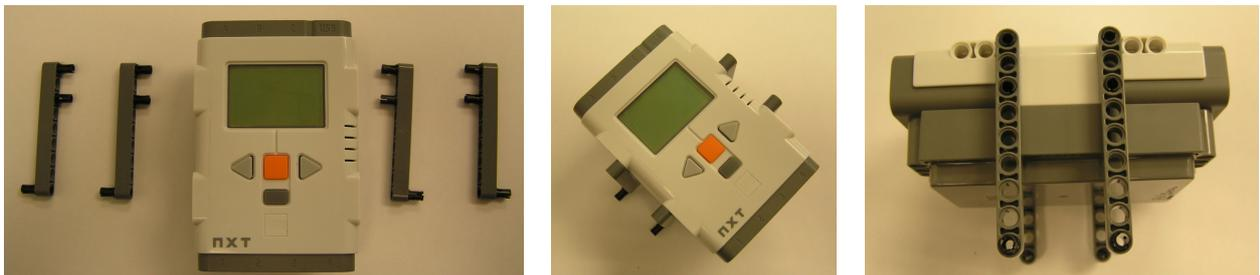
A continuación se ensambla el cuerpo con las tracciones utilizando los conectores p-p que quedaban libres. El resultado debe ser el siguiente:
