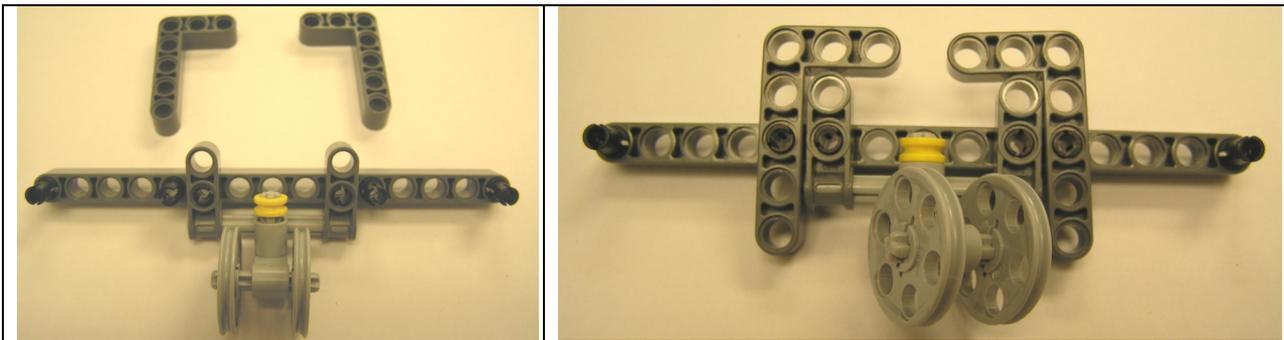
Ahora, unimos esta pieza con el cuerpo del robot según se ve en la figura. Los extremos de la barra15 se conectan a los pines de los motores, de modo que la estructura que da justo debajo de la pantalla del brick.
