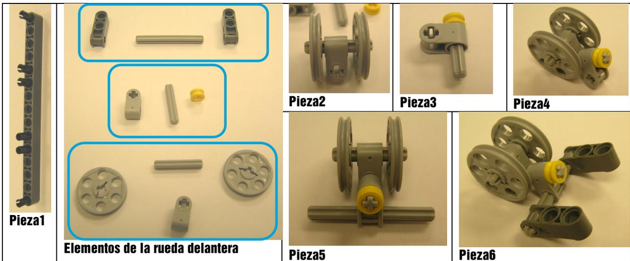
Finalmente colocamos la pieza6 en el medio de la pieza1 y nos ayudamos de dos escuadras 3-5 a 90° para reforzar la unión con el cuerpo central (brick).
